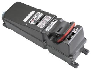
Four pole, Five wire Fusible Mechanical Interlock Receptacle.  $7.5\,\mathrm{HP}$  Standard,  $20\,\mathrm{HP}$  Max.  $3\,\mathrm{amp}$ ,  $600\,\mathrm{vac}$ .
